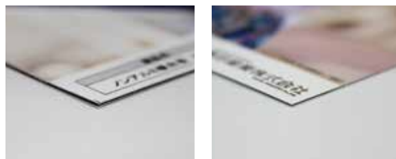
カッターナイフ断面 ロータリーカッター断面
